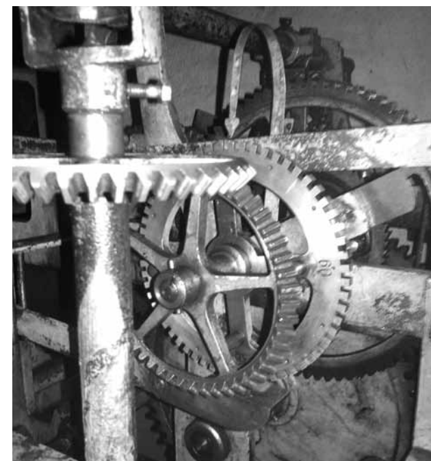
Buvusios Klaipėdos gaisrinės bokšto laikrodžio mechanizmas
